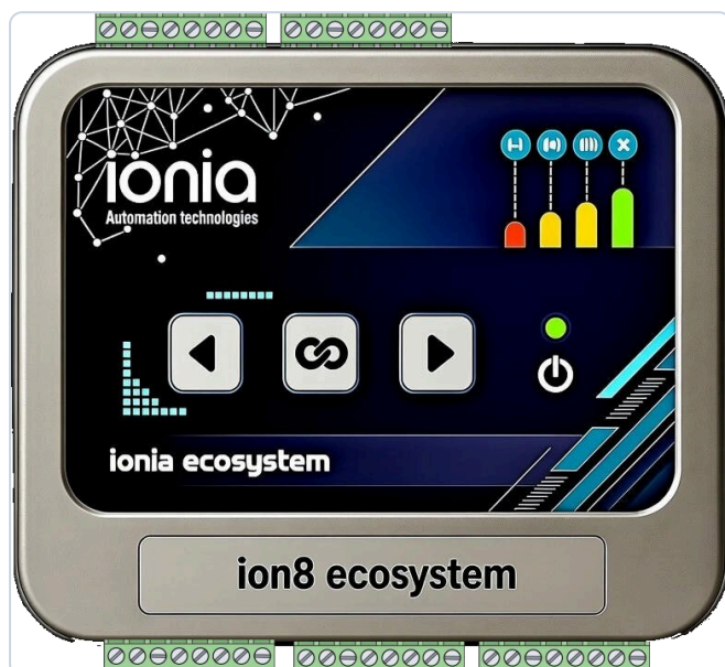
AS1111 Frontseite: vier Status-LEDs, drei Tasten und Klemmenblöcke
