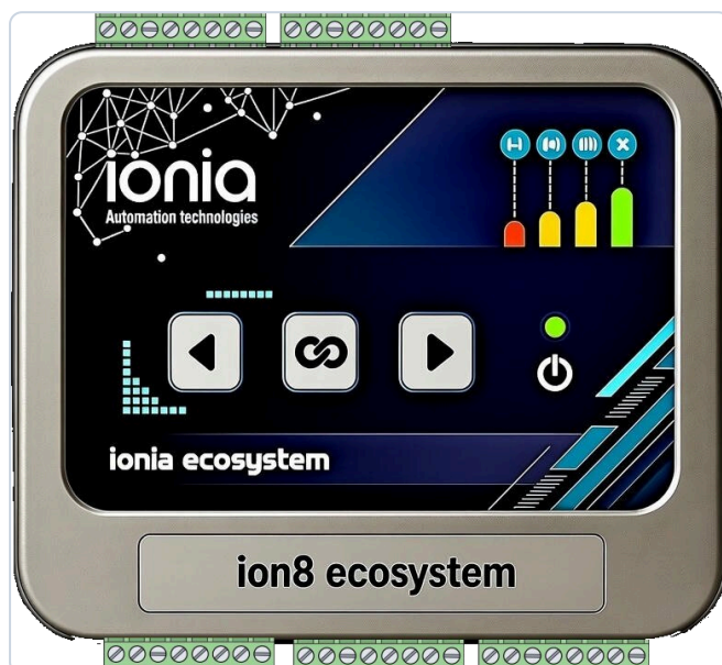
Frontal del AS1111: cuatro LED de estado, tres botones y bloques de bornes
