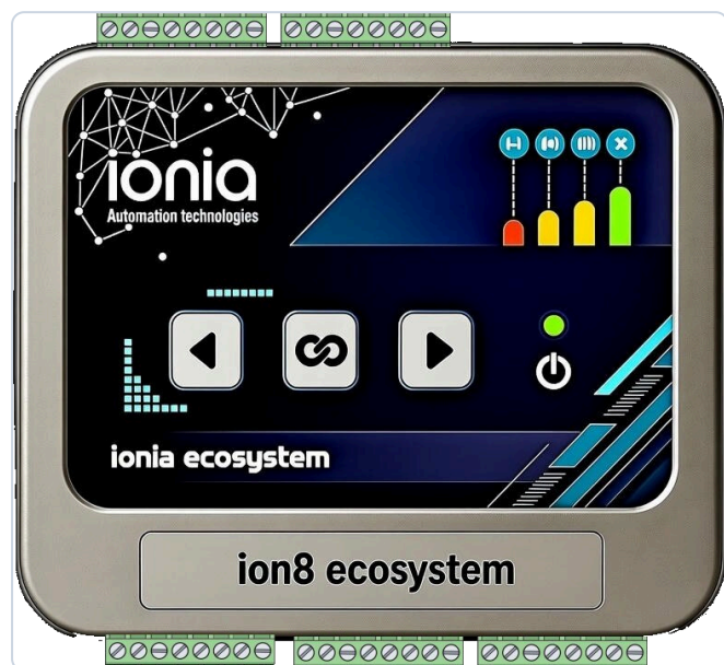
Frontale dell'AS1111: quattro LED di stato, tre pulsanti e morsettiere
