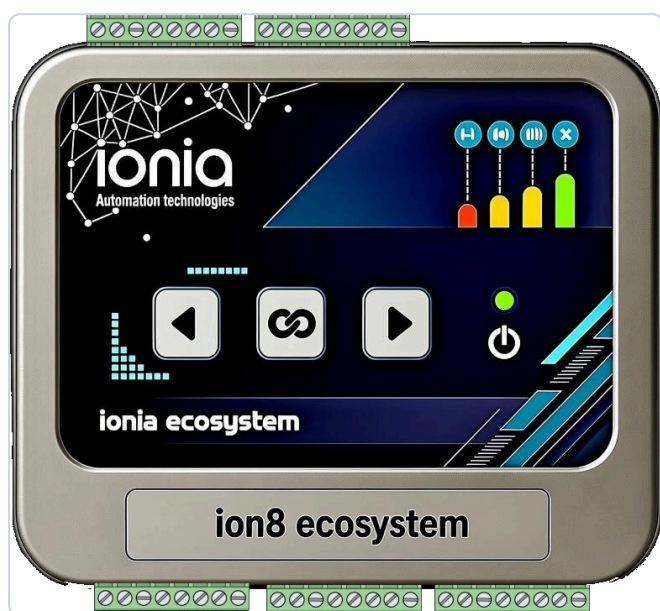
Передняя сторона AS1111: четыре индикатора состояния, три кнопки и клеммные колодки
